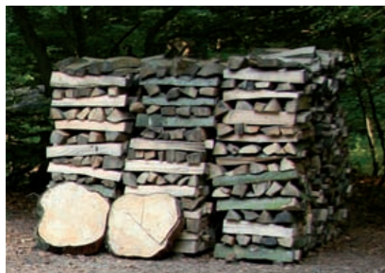
Afhængig af træart - og kulsviernes erfaring - bliver der ca 60 kg trækul af 300 kg træ.
